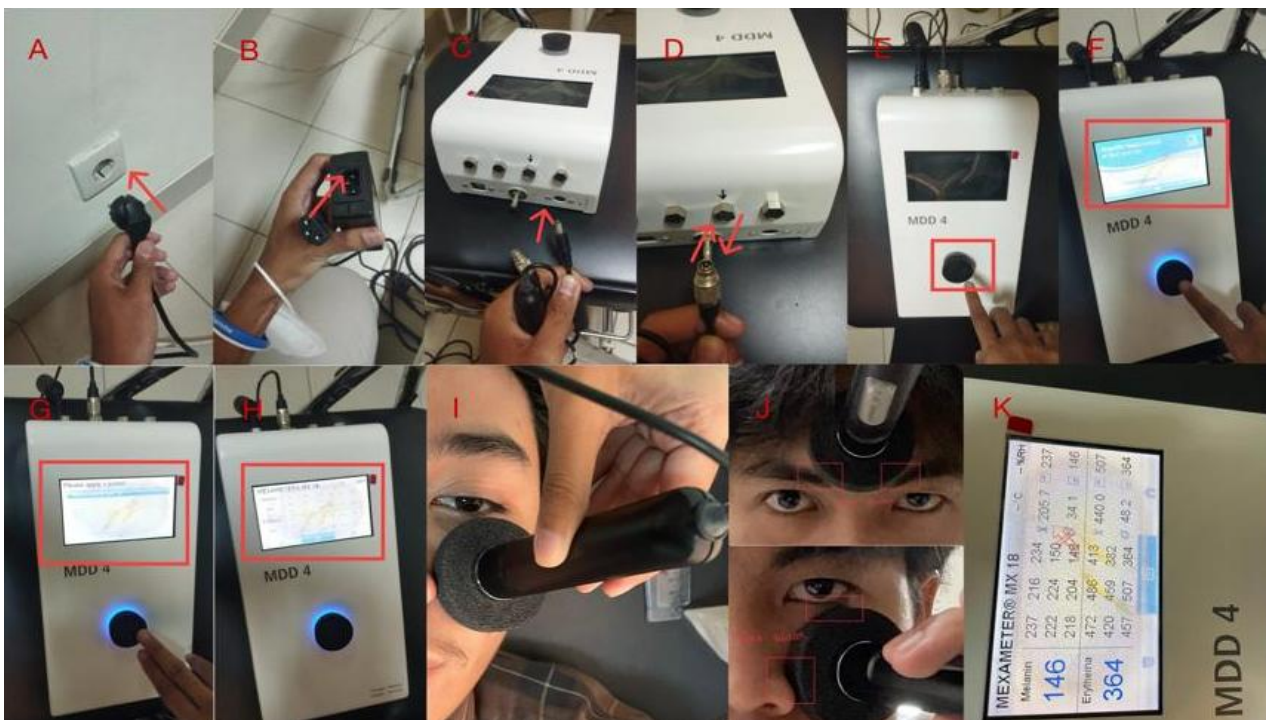
Gambar 1. Alur Pemakaian mexameter® MX-18 dan pengukuran indeks melanin
